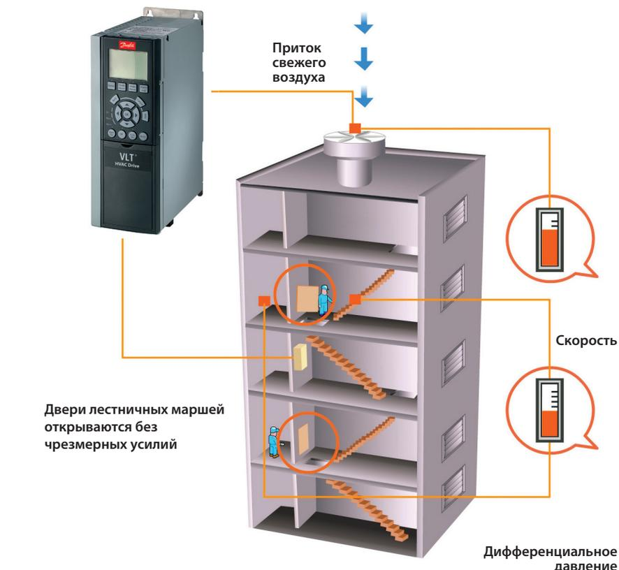
Вычисление значений расхода производится преобразователем частоты по внутренним показателям нагрузки двигателя. Первоначально необходимо провести «обучение» преобразователя
