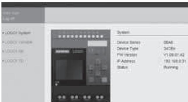
Все логические модули оснащены встроенным web сервером, парольный доступ к которому может выполняться с обычных и планшетных компьютеров Apple iPad, мобильных телефонов Apple iPhone, планшетных компьютеров и мобильных телефонов с операционной системой Android от V2.0.
