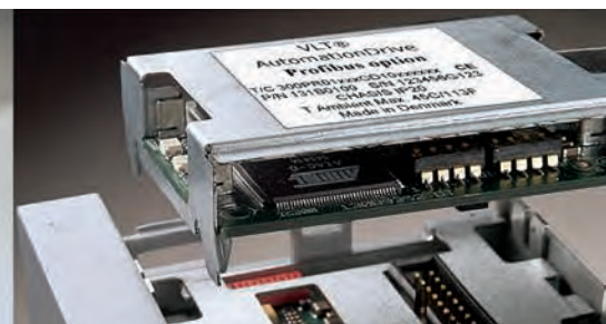
Сетевую шину (опция) можно без подготовки ставить под лицевой панелью. Ее можно перевернуть, если кабель должен быть вверху.
