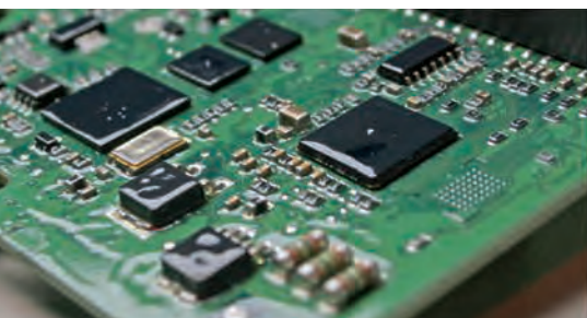
Для тяжелых условий эксплуатации предусмотрены печатные платы с защитным покрытием
